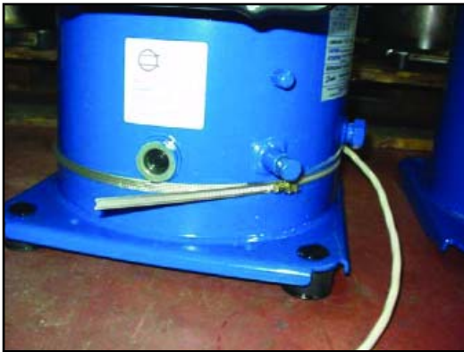
Рисунок 6.1: Установка ленточного подогревателя картера
